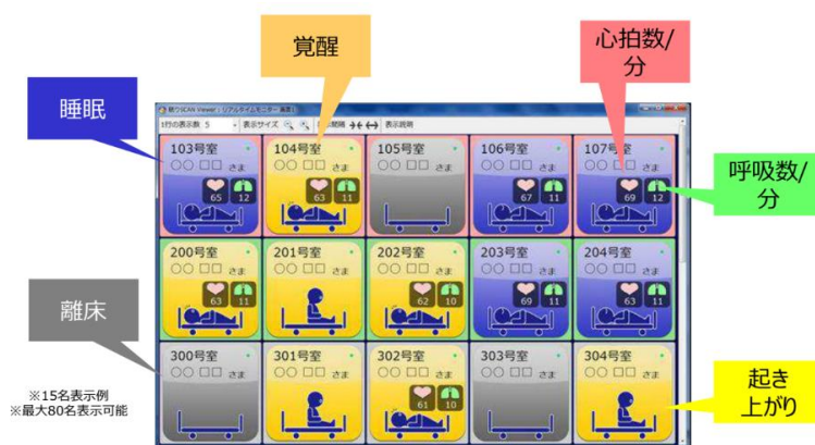
(例2) シルエット見守りセンサ (キング通信工業社)、スマートフォンでの状態一覧表示画面
