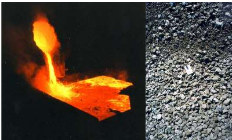
【溶融炉からの出 しゅっさい 滓状況】
