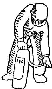
② ホースをはずし、親指でノズルの先端を押さえる。
